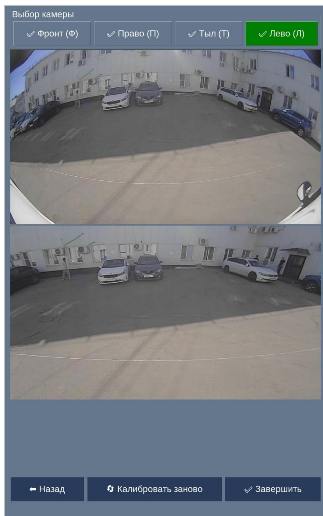
Рисунок 20 — Утилита для коррекции fish-eye искажений. Просмотр результата калибровки
