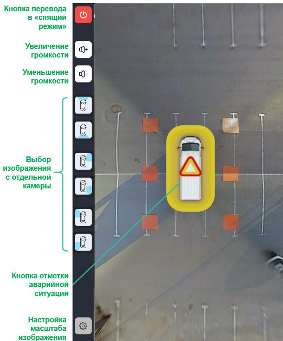
Рисунок 2 — АРМ Водителя. Главный экран. Интерфейс для 6-ти камер
